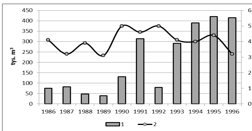
Ryc. 6. Depozycja rumowiska w korycie Kamy spowodowana przez zatory lodowe
