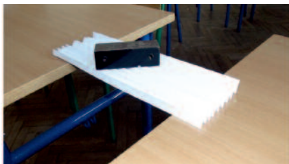
Zdjęcia 6 i 7. Konstrukcje papierowe o wytrzymałości 1 kg (niepoprawne i poprawne) Źródło: badania własne.
