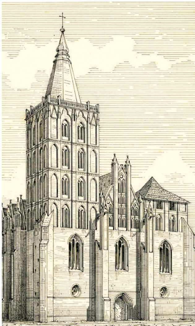
Il. 9. Fasada zachodnia wg inwentaryzacji Johanna Heisego przeprowadzona po zakończeniu remontu wieży w 1883 r. Blendy najwyższej kondygnacji wieży zamykają trójliscie, co wskazuje, iż korzystał z wcześniejszych, niezrealizowanych planów budowlanych (Die Bau- und Kunstdenkmäler des Kreises Kulm [bearbeitet J. Heise], Danzig 1887)
