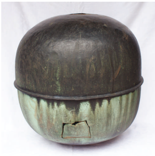
Il. 29. Kula z helmu kościoła parafialnego, w spodniej części rozcięcie, przez który wyjęte zostały złożone w niej świadectwa, na górnej półkuli widoczny napis, stan przed renowacją, XI 2009 (fot. M.G.Z.)
